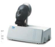
Dräger Prestor: высокопроизводительное устройство для проверки масок
