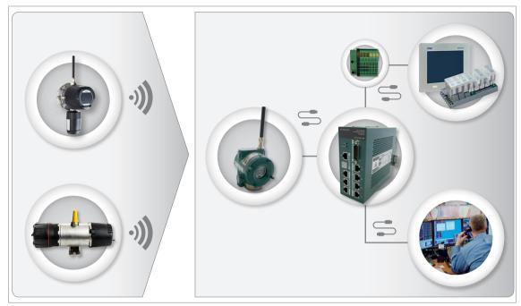
Dräger Polytron® 6100 EC WL передает сигнал в точку доступа. Затем сигнал ретранслируется в шлюз. Он подает сигнал напрямую в блок управления с помощью протокола связи Modbus/PROFINET®. Используйте ЦАП для аналоговых анализаторов.
